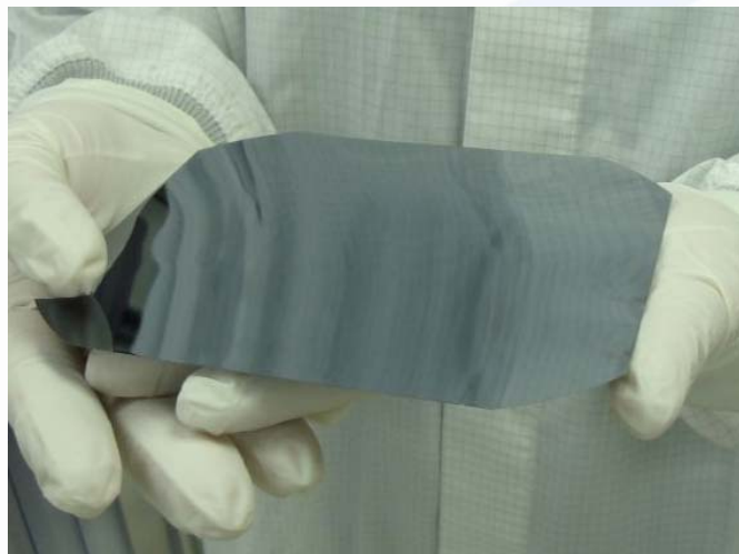
20um Mono c-Si Solar PV Foil
